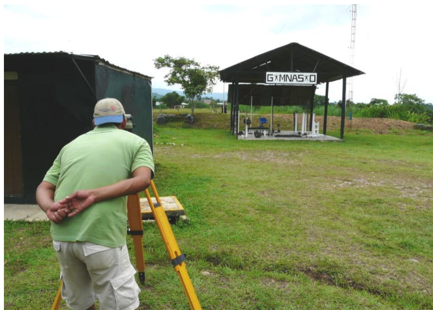
Fotografía 10.- Nivelación diferencial en Atalaya
