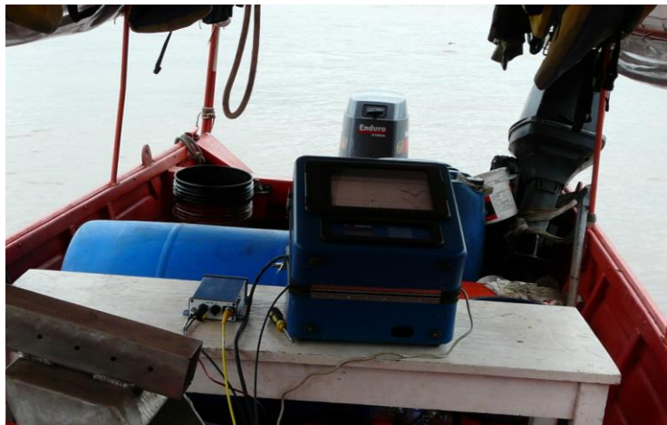
Fotografía 18.- Ecosonda y DGPS empleados en la batimetría
