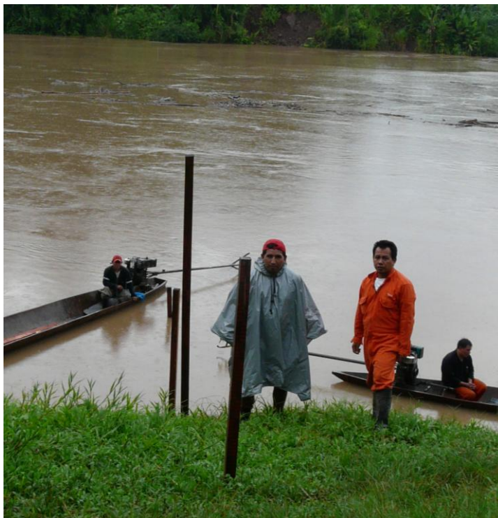
Fotografía 12.- Limnómetros instalados en el río Camisea
