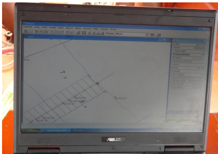
Fotografía 19.- Líneas planificadas de las secciones de batimetría en el software Hypack
