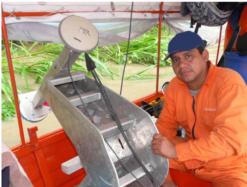
Fotografía 20.- El ADCP y el DGPS en el brazo basculante
