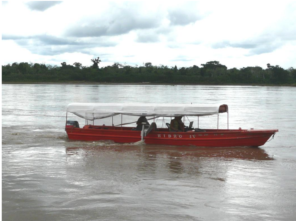
Fotografía 22.- Realizando un aforo con ADCP aguas arriba de la desembocadura del río Camisea
