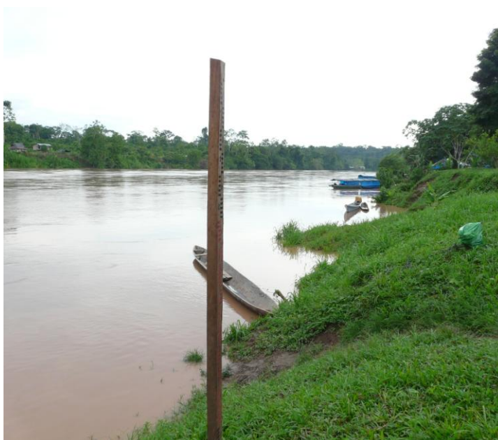
Fotografía 13.- Limnómetro fabricado con materiales encontrados en la zona de trabajo.
