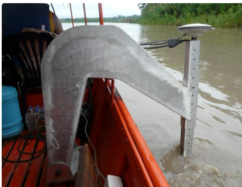
Fotografía 21.- Efectuando un aforo con el ADCP
