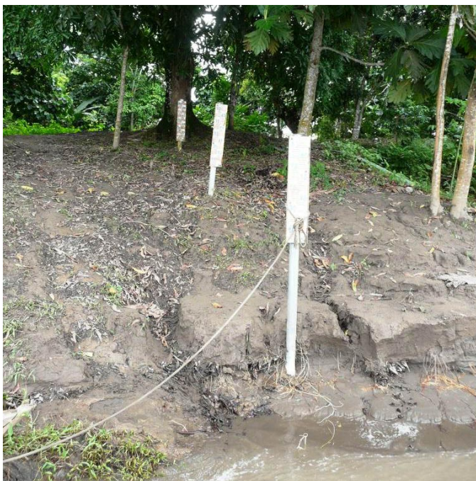
Fotografía 16.- Limnímetros encontrados en la CC.NN San Felipe
