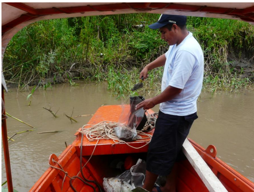
Fotografía 26.- Extrayendo una muestra de sedimentos de fondo
