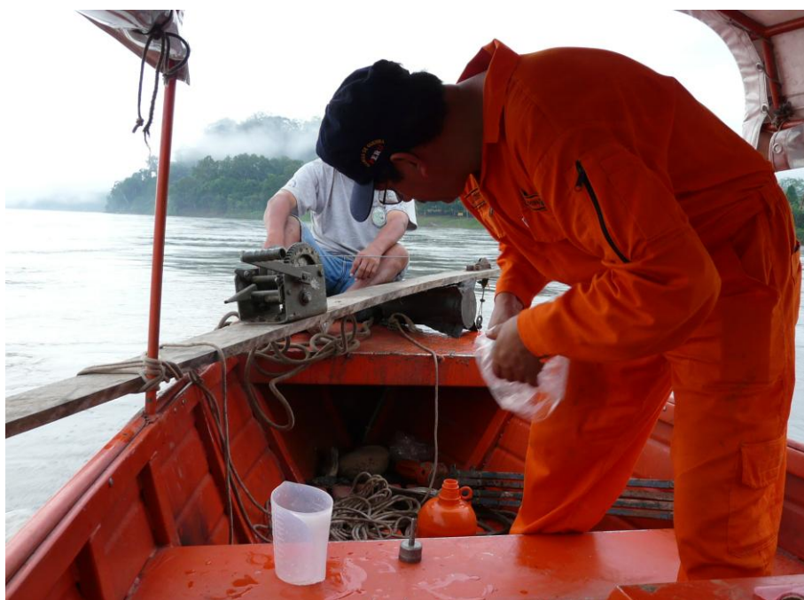
Fotografía 24.- Equipo para el muestreo de sedimentos en suspensión aguas abajo de la desembocadura del río Camisea
